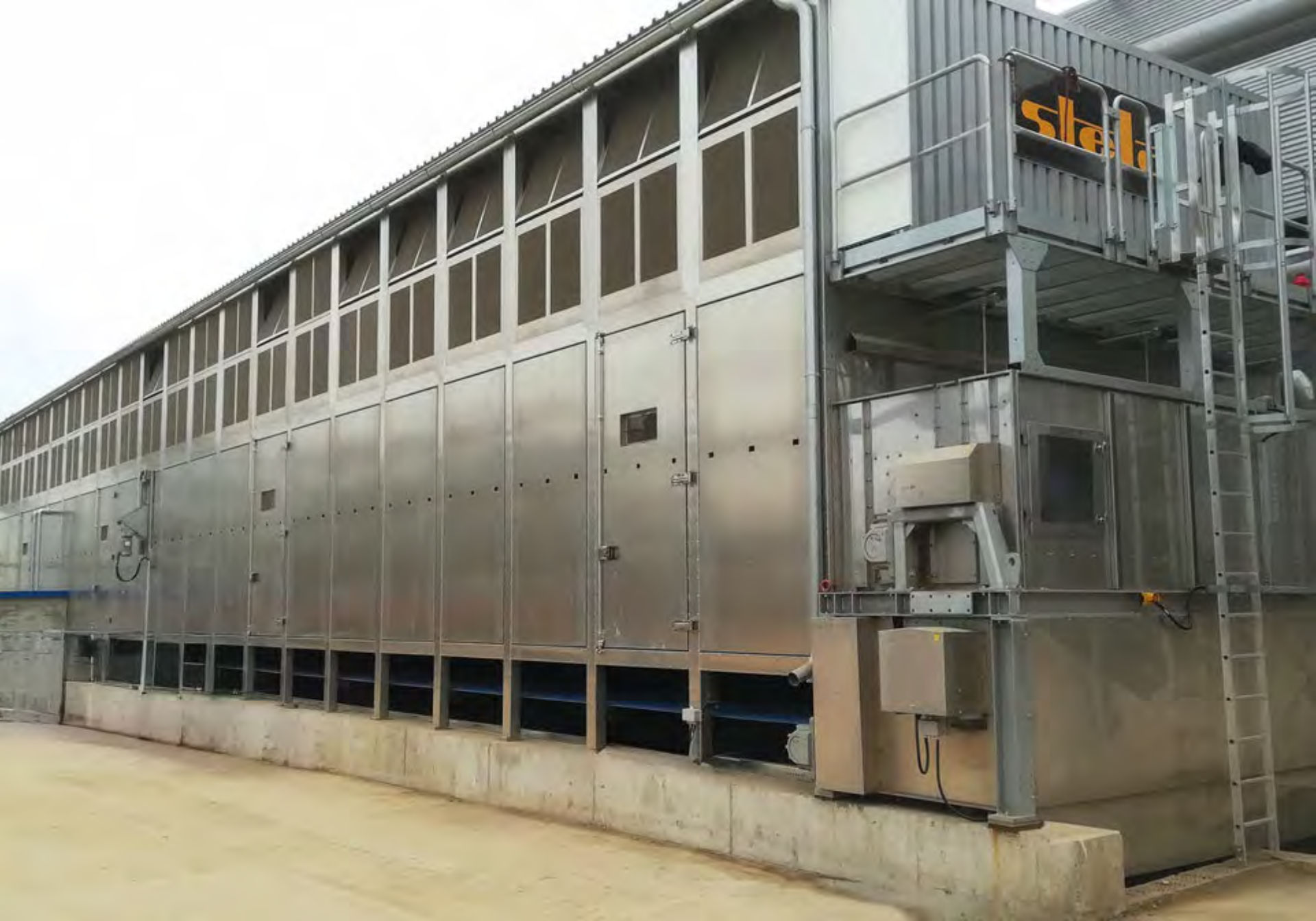
项目地：山东俏家装饰，中国 | 型号：BTU 1/6200-49.5-6/3 | 安装年份：2018 干燥物料：木屑 | 出料能力：约15.7吨/小时 | 降水区间：80% - 2%含水率
