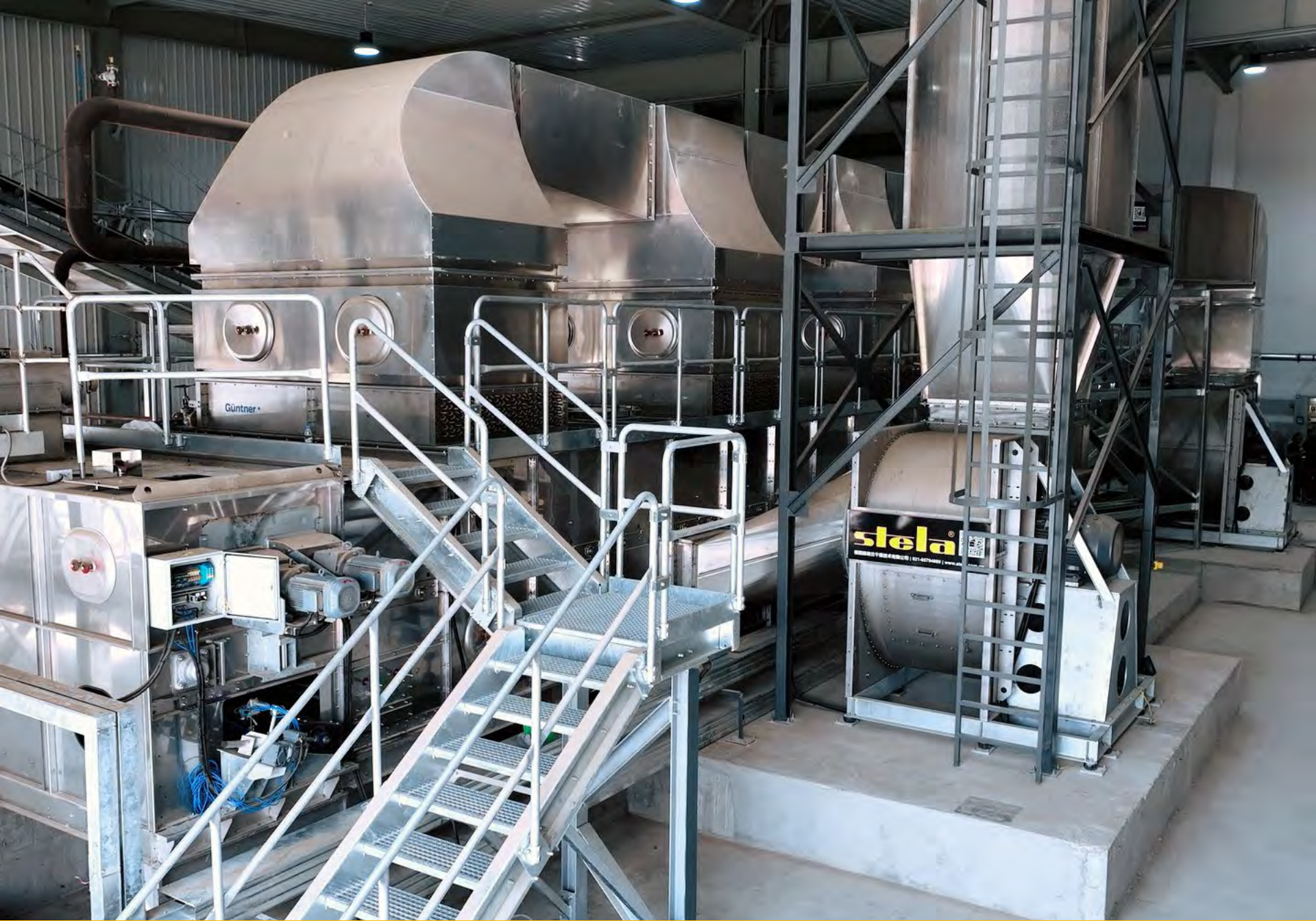
项目地：路德环境，中国 | 型号：BTLU 1/3000-23 | 安装年份：2024 干燥物料：酒糟 | 出料能力：约6.74吨/小时 | 降水区间：40% - 11%湿度
