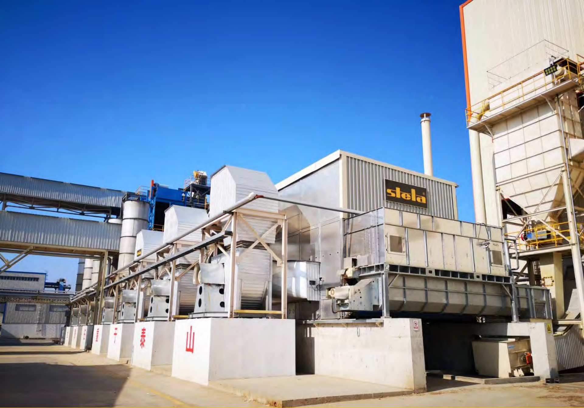
项目地：山东丰源，中国 | 型号：BTU 1/6200-60-8/3 | 安装年份：2018 干燥物料：OSB定向刨花板 | 出料能力：约15.0吨/小时 | 降水区间：100% - 2%含水率
