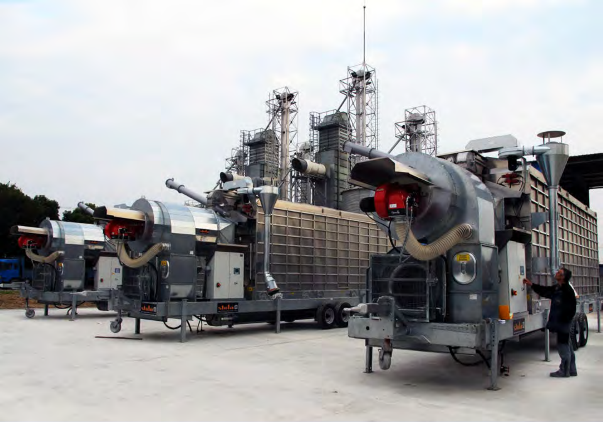
项目地：光明种业，中国上海 | 型号：3x MUF110 | 安装年份：2017 干燥物料：水稻种子 | 出料能力：约76.0吨/小时 | 降水区间：26% - 13%湿度
